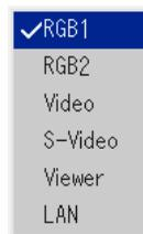
Drücken Sie kurz die SOURCE-Taste am Projektorgehäuse, um die Quellen-Liste anzeigen zu lassen. Bei jeder Betätigung der SOURCE-Taste ändert sich die Eingangsquelle wie folgt: "Video" (VCR, Dokumentenkamera oder LaserDisc-Player), S-Video, "RGB1" oder "RGB2" (Computer oder DVD mit Komponenten-Ausgang), "Viewer" (Dias auf einer PC-Karte) oder "LAN" (von einem PC empfangenes verdrahtetes oder drahtloses Signal). Drücken Sie zum Anzeigen der ausgewählten Quelle ein paarmal die ENTER-Taste.
