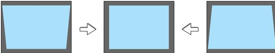
1. Drücken Sie die **3D REFORM-Taste** auf der Fernbedienung oder dem Projektorgehäuse.
