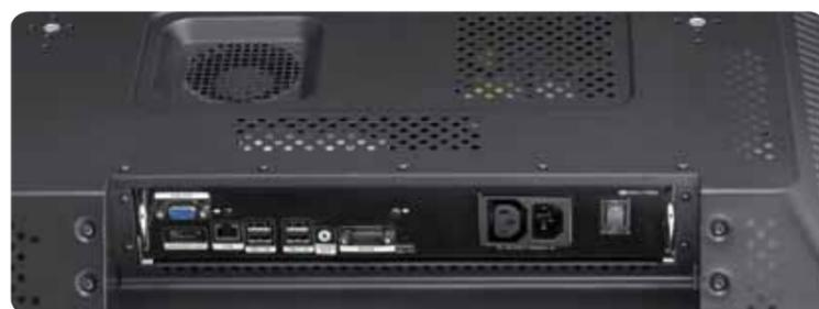
Einschubschacht mit Samsung Slide-in-Module (SIM-NT)
